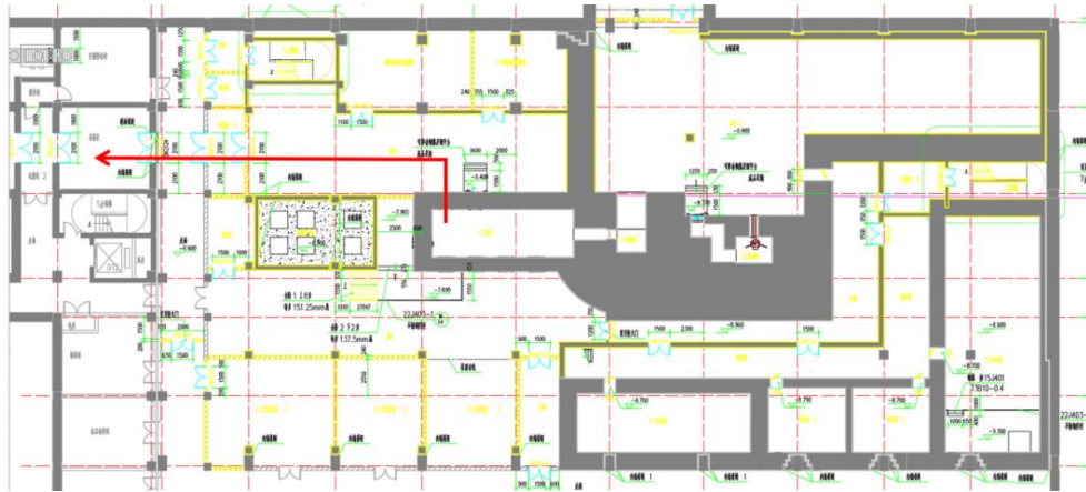
图 3-19 操作热室外屏蔽转运容器（含辐照完靶片）转运路线
