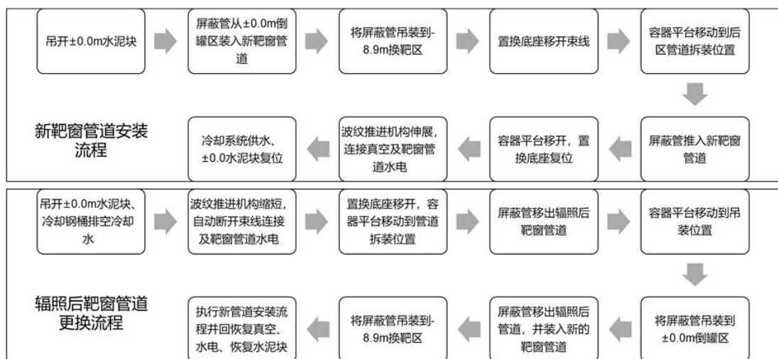
图 3-31 新靶窗管道安装及辐照后靶窗管道更换作业流程
